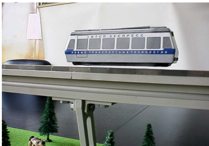
Действующая модель с ВТСП подвесом
