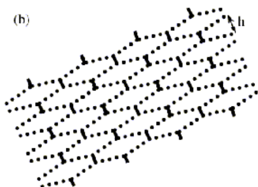
Рис. 1. (а) ПЭМ изображение «композитной подложки» с полученной регулярной дислокационной сеткой. Прямоугольником выделена поверхностная полость, образовавшаяся в результате несовершенства поверхностей. (б) Схема, расшифровывающая рис. 1а. Пунктирными линиями показаны смешанные дислокации, сплошными – винтовые.
